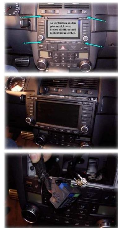
2. Quadlockstecker auf der Rückseite des Navigationsrechners herausziehen und mit dem Kabelsatz TV-VN01 verbinden.
