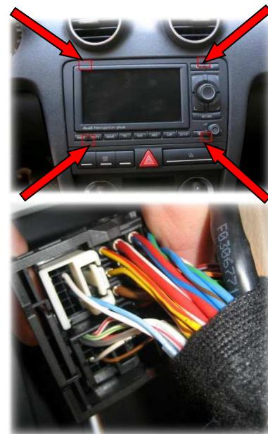
2. Quadlockstecker auf der Rückseite des Navigationsrechners herausziehen und mit dem Kabelsatz TV-VN01 verbinden.
