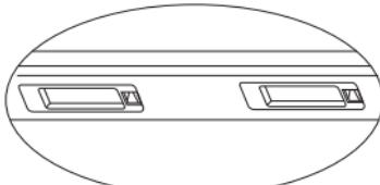
1. Installieren Sie die KAX802 in die Halterung Ihrer Nummernschildbeleuchtung. Demontieren Sie dazu die Halterung und bohren ein 8 mm Loch.
