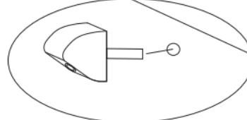
Führen Sie das Kabel und das Gewinde durch das Loch und befestigen die Kamera mit Scheibe und Mutter.
