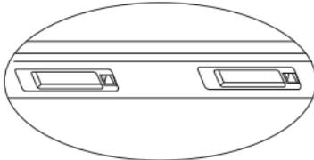
1. Installieren Sie die KCA801 in die Halterung Ihrer Nummernschildbeleuchtung. Demontieren Sie dazu die Halterung und bohren ein 8 mm Loch.
