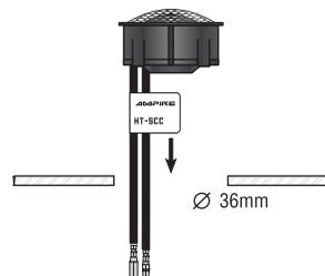
Installieren Sie die Hochtöner wie beschrieben. Jetzt verbinden Sie die Anschlüsse der Hochtöner mit den Anschlüssen der FWHT-SCC Frequenzweiche. Verbinden Sie anschließend die Eingänge der Frequenzweiche (silber-blau = plus, silber = minus) mit Ihrem Radio oder Verstärker. Achten Sie auf die richtige Polarität.
