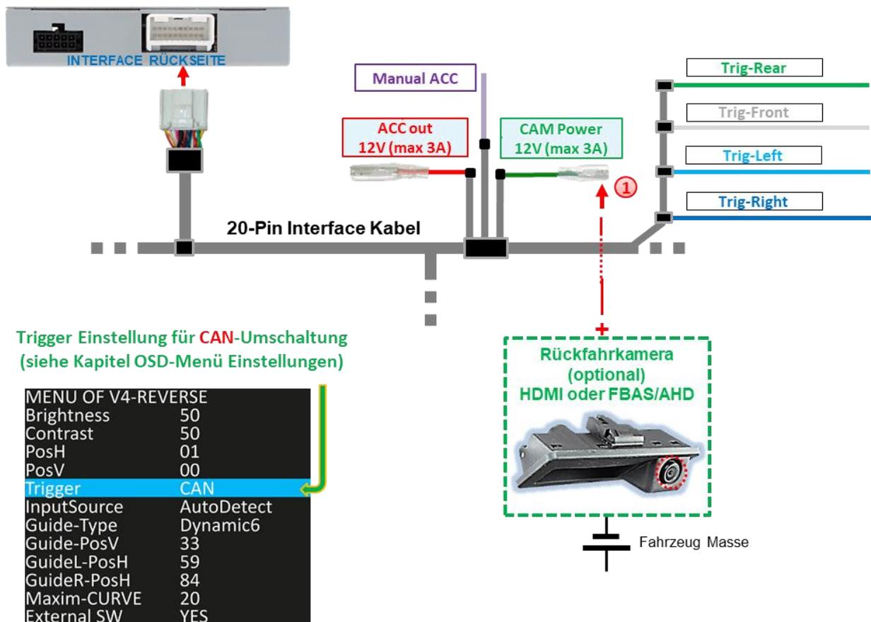
**1** Die +12V Spannungsversorgung für die After-Market Rückfahrkamera kann über die **grüne Leitung CAM Power 12V (max 3A)** des **20-Pin Interface Kabels** erfolgen, da diese Leitung ausschließlich während Kamera-Eingänge aufgeschaltet sind stromführend ist (manche Kameras sind nicht Dauerstrom-stabil).
