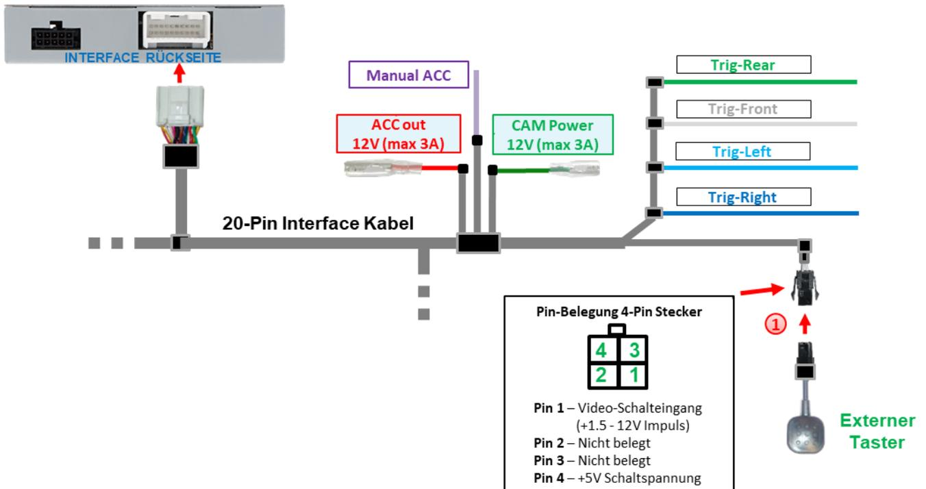
1 4-Pin Buchse des externen Tasters mit 4-Pin Stecker des **20-Pin Interface Kabels** verbinden.
