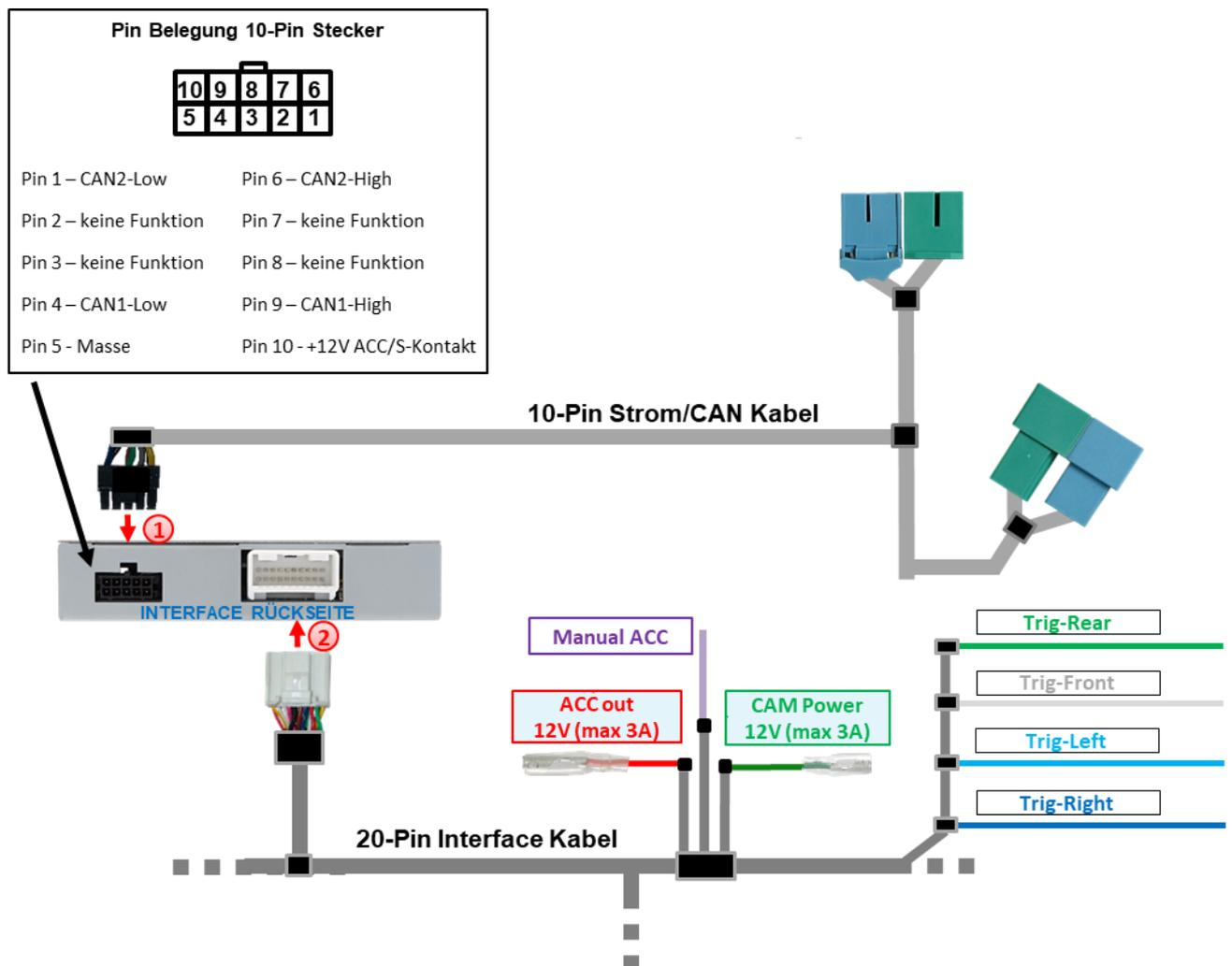
**1** Die 10-Pin Buchse des **10-Pin Strom/CAN Kabels** mit dem 10-Pin Stecker des Interface verbinden.
