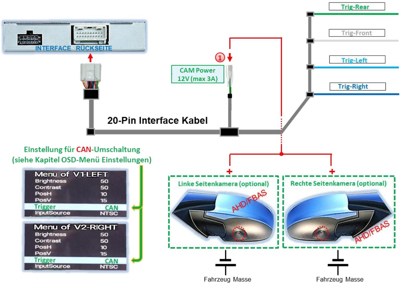
**1** Spannungsversorgung für die Seitenkameras kann über **grüne Leitung CAM Power 12V (max 3A)** des 20-Pin Interface Kabels erfolgen, da diese Leitung ausschließlich während Kamera-Aktivierungen stromführend ist (manche Kameras sind nicht Dauerstrom-stabil).
