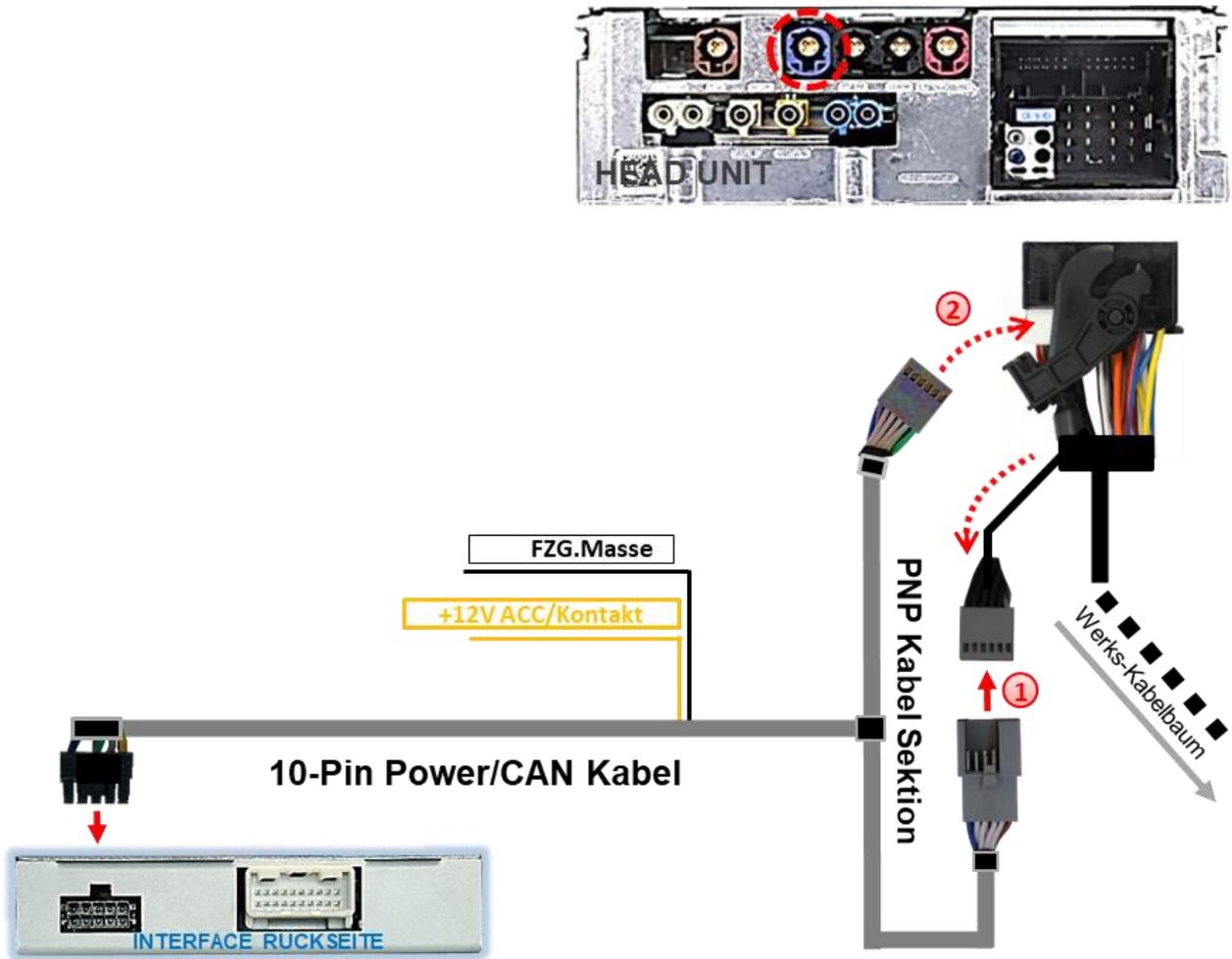
① Die Quadlockbuchse des Fahrzeugkabelbaums an der Rückseite der Head-Unit abstecken und die daraus zuvor ausgeklippte schwarze 12-Pin CAN Buchse (siehe Graphik) am 12-Pin Stecker des PNP-Kabelsatzes anschließen.
