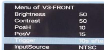
„**Delay**“-Funktion für Frontkamera. Mit der „**Delay**“-Einstellung wird die automatische Umschaltung einer am **V3-Front**-Eingang angeschlossenen Frontkamera nach Auslegen des Rückwärtsganges sowie ihre Anzeige-Dauer auf dem Display bestimmt. Verfügbar sind 5s after REV, 10s after REV, 15s after REV, 20s after REV.
