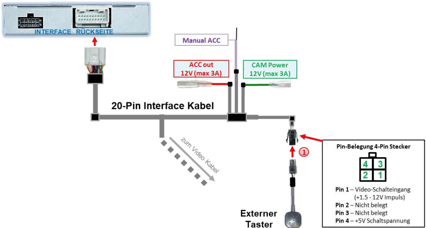
① 4-Pin Buchse des externen Tasters mit 4-Pin Stecker des **20-Pin Interface Kabels** verbinden.
