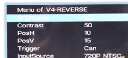
„**CAN**“-Funktion mit **CAN-Bus Anschluss**. Mit der „**CAN**“-Einstellung wird bei Einlegen des Rückfahrganges automatisch umgeschaltet auf **V4 Reverse/ HDMI\*** für CVBS/AHD Rückfahrkamera. Voraussetzung ist das Interface erkennt den Rückfahrgang im CAN-Bus.
