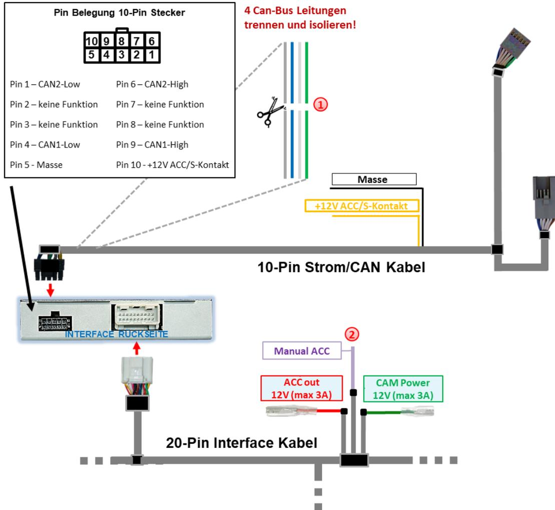
① Die 4 CAN-Bus Leitungen (grau, blau, weiß und grün) des 20-Pin Interface Kabels ca. 4-5 cm hinter dem schwarzen Stecker trennen und isolieren.
