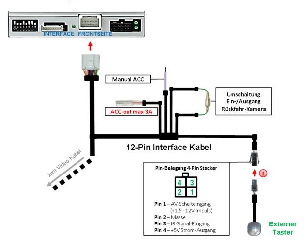
1 Die 4-Pin Buchse des externen Tasters mit dem 4-Pin Stecker des Video-Interface verbinden.
