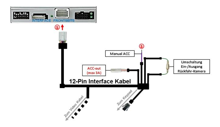
Die violett farbene Leitung Manual ACC des 12-Pin Interface Kabels an +12V Zündstrom oder +12V S-Kontakt Klemme 86s +12V (z.B. Handschuhfachbeleuchtung) anschließen.
