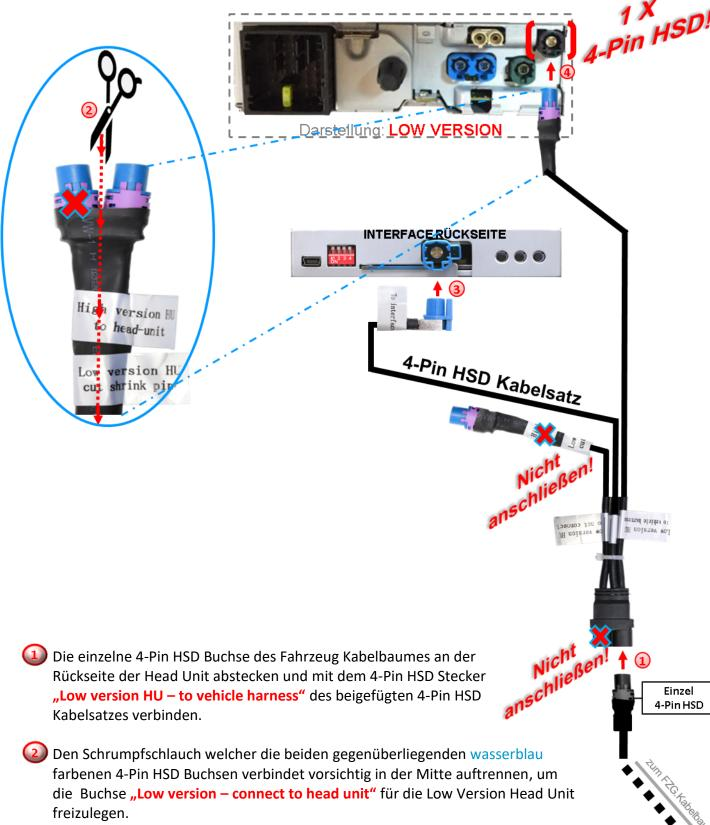
Die freigelegte wasserblau farbene 4-Pin HSD Buchse "Low version – connect to head unit" mit dem zuvor freigewordenen schwarzen 4-Pin HSD Stecker der Head Unit verbinden.
