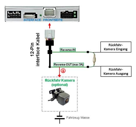
Die 12V Stromversorgung für die After-Market Rückfahrkamera (max. 3A) erfolgt durch Anschließen an die grüne Leitung um einen unnötigen Dauerbetrieb der Kameraelektronik zu vermeiden.
