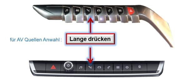
Langes Drücken der "Navi"-Taste des Infotainments schaltet den Eingang vom Werksvideo zu den eingespeisten Videoquellen um. Wenn alle Eingänge per Dip Switch Einstellung aktiviert sind, ist die Reihenfolge wie folgt:
