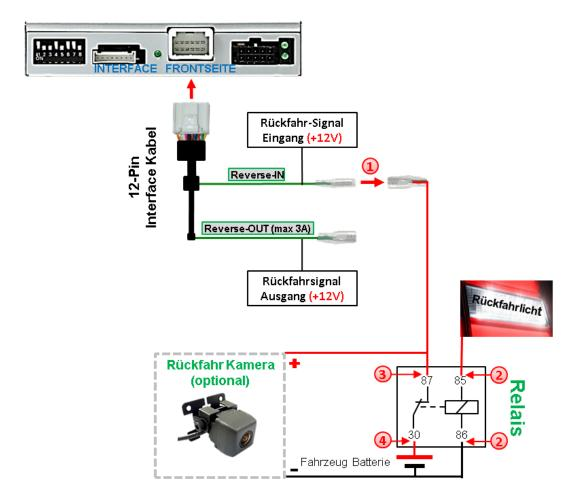
Stecker und Buchse der grünen Kabelverbindung des 20-Pin Kabels voneinander trennen und das grüne Eingangskabel "Reverse-IN" mit der Ausgangsklemme (87) des Relais verbinden.
