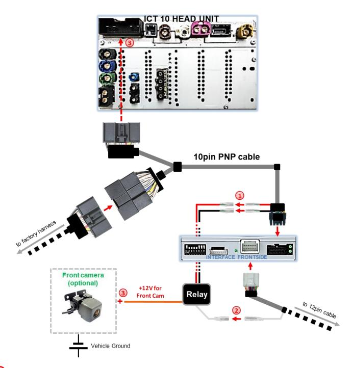
Die Stecker der einzelnen roten und schwarzen Leitung des 10-Pin PNP Kabels an den Buchsen der einzelnen roten und schwarzen Leitung des Relais anschließen.
