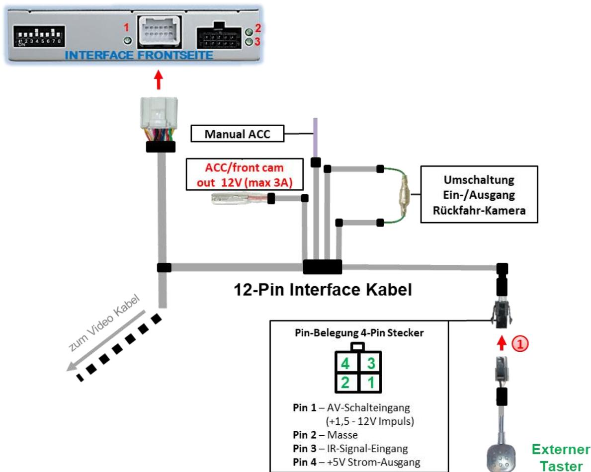
① Die 4-Pin Buchse des externen Tasters an dem 4-Pin Stecker des Video-Interface anschließen.
