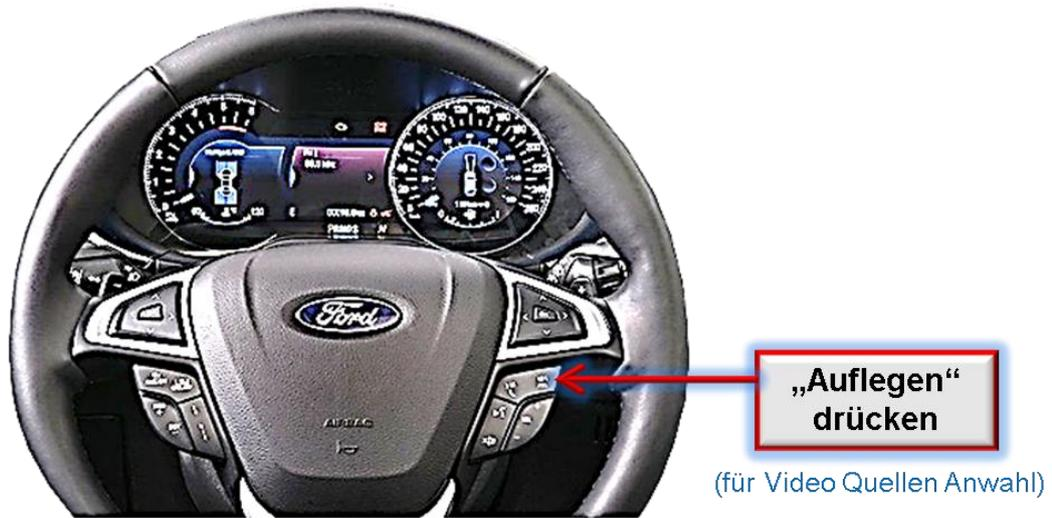
Das Umschalten der Video Quellen erfolgt mit langem Drücken der **Auflegen Taste**. Jedes Drücken (ca. 2-3 Sekunden) wechselt zum nächsten aktivierten Eingang. Wenn alle Eingänge aktiviert sind, ist die Reihenfolge:
