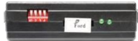
**Nach jeder Veränderung der Dip-Schalter-Einstellung muss ein Strom-Reset der CAN-Box durchgeführt werden!**
