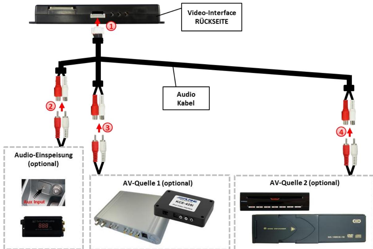
**Hinweis:** Wenn nur eine AV-Quelle angeschlossen werden soll, kann der Video-Ausgang der Quelle mit Video IN1 des Video-Interface und der Audio-Ausgang der AV-Quelle direkt mit der Audio-Einspeisung verbunden werden.
