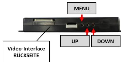
Nach der Installation müssen die Bildeinstellungen mit den Tasten des Video-Interface angepasst werden. Die Tasten sind in das Gehäuse eingelassen, um unbeabsichtigte Veränderungen während und nach der Installation zu vermeiden. Durch Drücken der Taste MENU kann das Menü Einstellungen als OSD geöffnet und zur nächsten Einstellung gewechselt werden. UP und DOWN verändern die entsprechenden Einstellungen.
