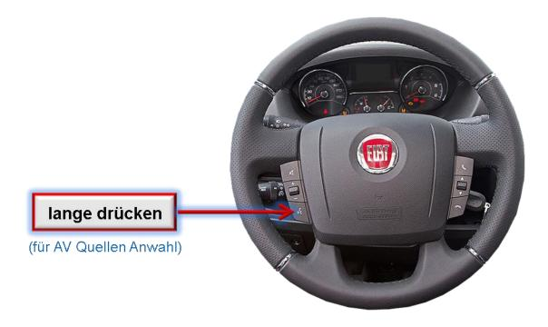
Die Sprachbefehl-Taste am Lenkrad schaltet den Eingang vom Werksvideo zu den eingespeisten Videoquellen um. Wenn alle Eingänge per Dip Switch Einstellung aktiviert sind, ist die Reihenfolge wie folgt:
