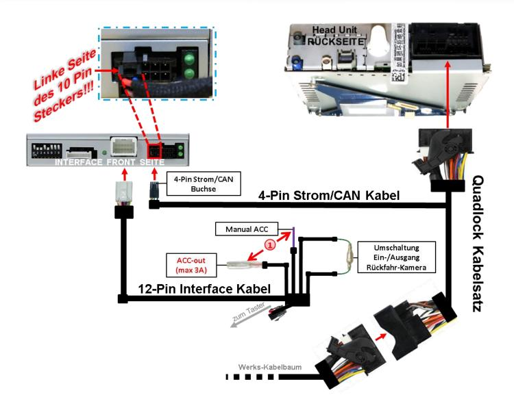
Sollte nach Anschluss des 20-Pin PNP Kabelsatzes bei eingeschalteter Zündung keine Interface LED leuchten, müssen zusätzlich die rote Leitung ACC-out (max 3A) und die lila farbene Leitung Manual ACC des 12-Pin Interface Kabels an +12V S-Kontakt Klemme 86s (z.B. Handschuhfachbeleuchtung) angeschlossen werden.
