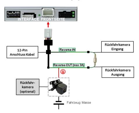
Die 12V Stromversorgung für die After-Market Rückfahrkamera (max. 3A) erfolgt durch Anschließen an die grüne Leitung um einen unnötigen Dauerbetrieb der Kameraelektronik zu vermeiden. Die beiden grünen Kabel "Reverse-IN" und "Reverse-OUT" müssen für den Betrieb miteinander verbunden bleiben.
