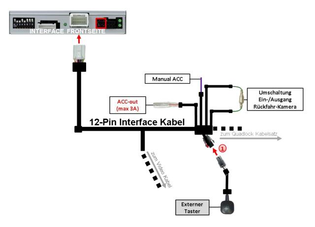
Die 4-Pin Buchse des externen Tasters mit dem 4-Pin Stecker des Video-Interface verbinden.
