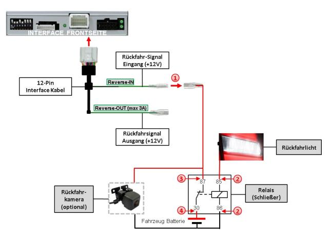
1 Stecker und Buchse der grünen Kabelverbindung des 20-Pin Kabels voneinander trennen und das grüne Eingangskabel "Reverse-IN" mit der Ausgangsklemme (87) des Relais verbinden.
