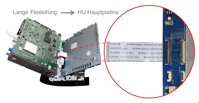
Nach Überprüfung der fehlerfreien Flexleitungsmontage erfolgt die Wiedermontage des Bedienteils sowie des Ersatz - Gehäusebodens in umgekehrter Reihenfolge
