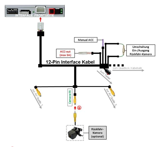
Den Video Cinch-Stecker der After-Market Rückfahrkamera mit der Cinch-Buchse "Camera-IN" am Videokabel des Video-Interface verbinden.
