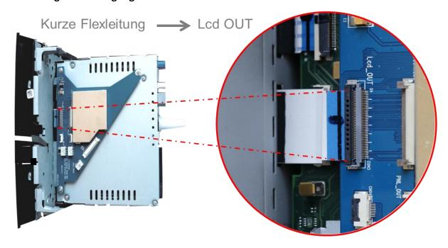
Die vormontierte 40-Pin Flexleitung des Tochter PCB an dem zuvor freigewordenen Flexleitungssockel der Head-Unit Hauptplatine anschließen (nachstehende Warnhinweise beachten!).
