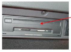
Original Radio herausnehmen, Quadlock-Buchse abstecken und Y-Kabelsatz anschließen
