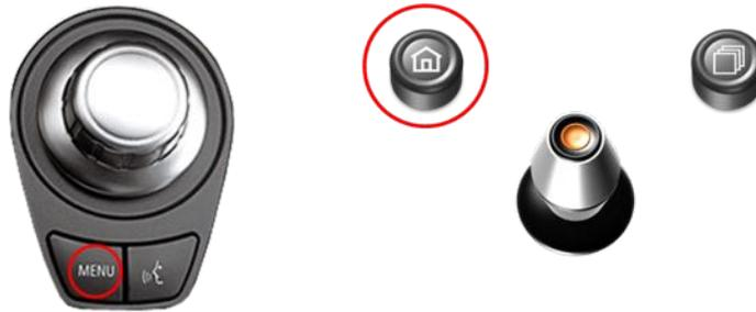
Im **BMW** im **Entertainment** Menü des Fahrzeugs **AUX** und im **Mini** im **CD/Multimedia** Menü des Fahrzeugs **AUX vorn** über den iDrive aktivieren und dann **MENU** (1- und 2-tasten iDrive + Mini) **lange drücken**, um das Interface als aktuelle AV-Quelle anzuwählen.
