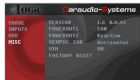
③ Bei einigen Fahrzeugen ist das Rückwärtgangsignal nicht auf dem CAN-Bus vorhanden. Sollte das Interface nach der Installation und dem hier beschriebenen OSD-Setup (siehe nächstes Kapitel) nicht automatisch auf die Rückfahrkamera umschalten, so muss das weiße Kabel des Kabelsatzes V4C-BM03 an das Rückfahrsignal (+12V des Rückfahrlichts) angeschlossen werden.
