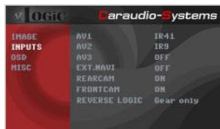
**Hinweis:** Auf dem IR-Steuerkanal AV1 ist für IR-41 kompatible DVB-T Tuner voreingestellt.
