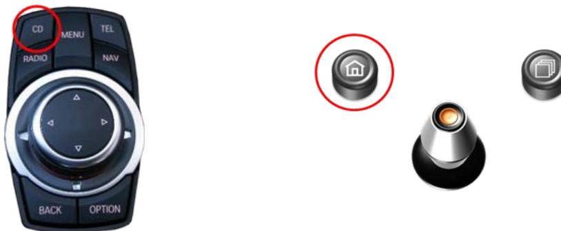
Im **CD/Multimedia** Menü des Fahrzeugs **AUX vorn** über den iDrive aktivieren und dann die **CD-Taste** bzw. die **Menü-Taste lange drücken**, um das v.LOGiC als aktuelle AV-Quelle anzuwählen.
