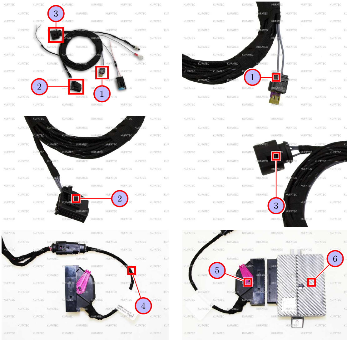
Abbildung 4: Anschluss Kabelsatz PRO & EXTENDED
