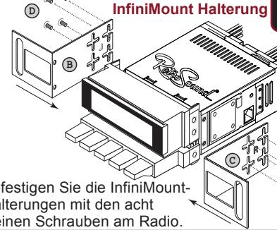
Befestigen Sie die InfiniMount-Halterungen mit den acht kleinen Schrauben am Radio.
