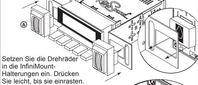
Setzen Sie die Drehräder in die InfiniMount-Halterungen ein. Drücken Sie leicht, bis sie einrasten.
