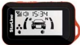
Die Lebensdauer der Batterie im LCD-Handsender beträgt je nach Betriebsbedingungen bis zu 4 Monate. Verwenden Sie für einen Handsender mit LCD eine AAA-Batterie
