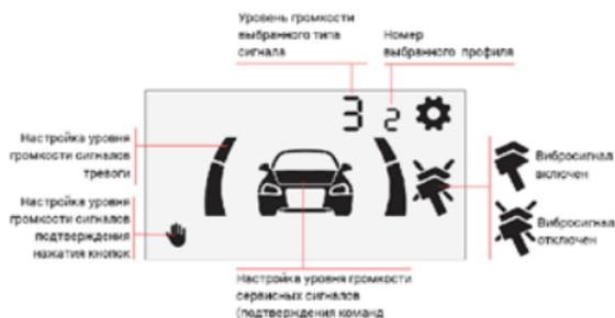
Das Umschalten zwischen den Signalen innerhalb der Profile erfolgt durch kurzes Drücken der Taste **1**. Verringern oder Erhöhen Sie die Lautstärke durch kurzes Drücken der Taste **2** bzw. **3**.
