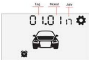
4. Stellen Sie mit einem kurzen Tastendruck **2** das aktuelle Datum ein, mit einem kurzen Tastendruck **3** den aktuellen Monat, mit einem kurzen Tastendruck **4** das aktuelle Jahr.
