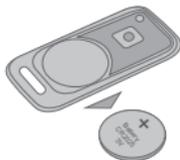
2. Drücken und halten Sie die Taste des TAG gedrückt und legen Sie die Batterie ein. Die TAG LED leuchtet rot.
