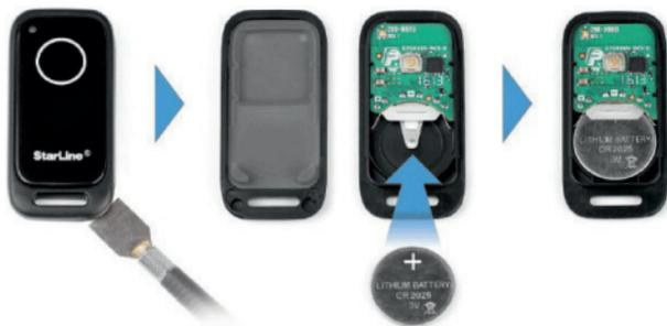
Um ein Fahrzeug, was mit der i96 CAN ausgestattet ist, zu fahren muss der BT TAG mitgeführt werden. Sobald der TAG in Reichweite der Zentrale ist, findet ein Datenaustausch über die verschlüsselte Bluetooth Verbindung statt. Ein Smartphone kann auch als BT TAG mit der Zentrale gekoppelt werden.
